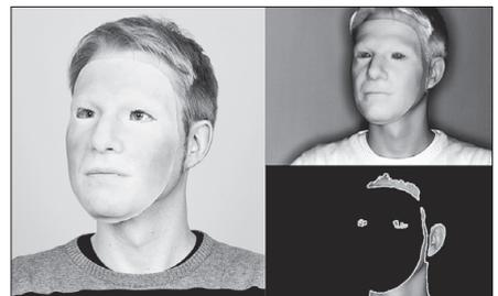
Links ist ein Täuschungsversuch einer RGB-Kamera zu sehen. Auf der rechten Seite sind die Bilder der in dem Forschungsprojekt verwendeten NIR-Kamera zu sehen.
